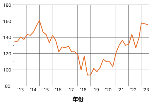
土木工程拓展署土木工程投标价格指数
